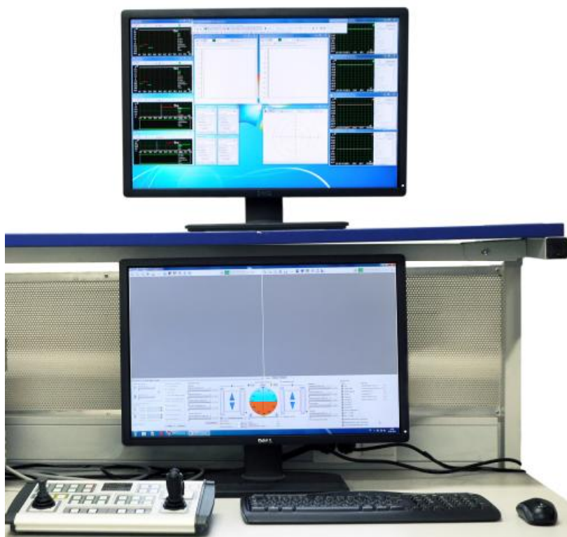
Рисунок 2 – Внешний вид пульта управления ПУ-ВСД-М и компьютера оператора/контролера с установленным программным комплексом ВТД
