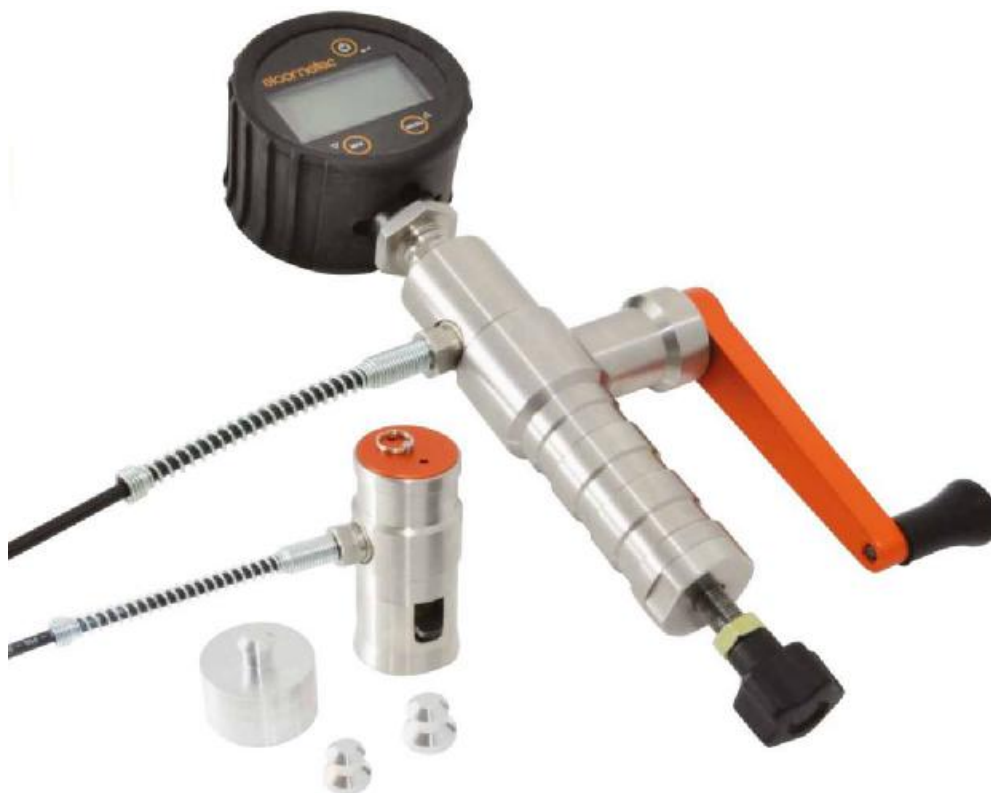
Рисунок 1 – Общий вид адгезиметра покрытий ELCOMETER 506
