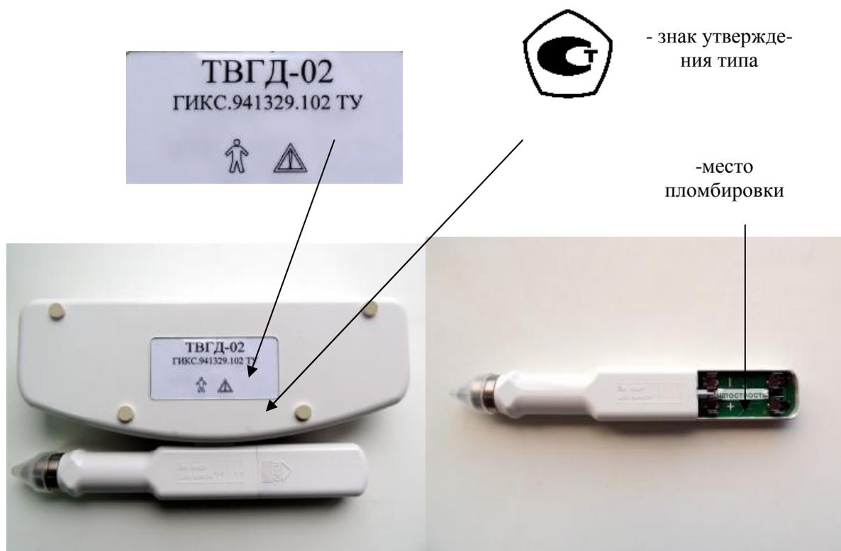
Рисунок 2 – Схема маркировки и пломбировки тонометров
