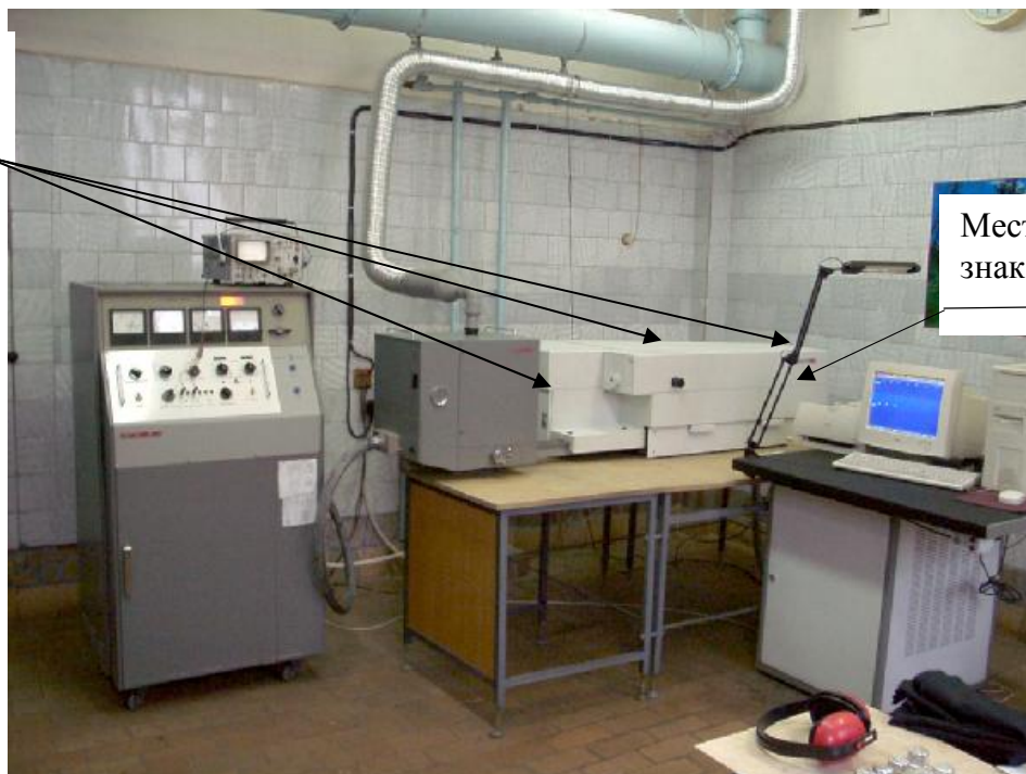
Рисунок 1 – Внешний вид спектрометра эмиссионного МФС-8 «СЛ»
