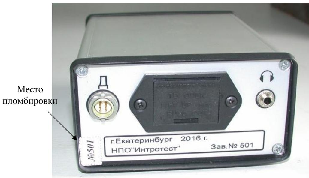
Рисунок 2 – Схема пломбировки электронного блока дефектоскопа вихретокового ВИТ-4
