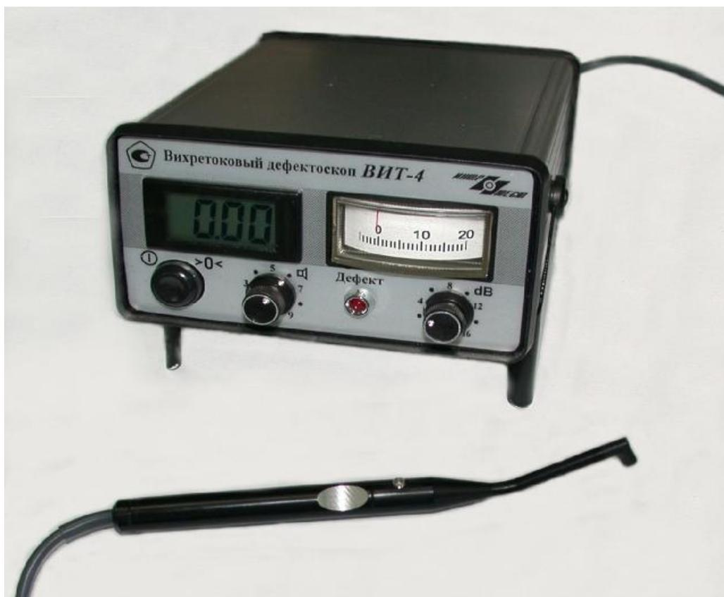
Рисунок 1 – Общий вид дефектоскопа вихретокового ВИТ-4
