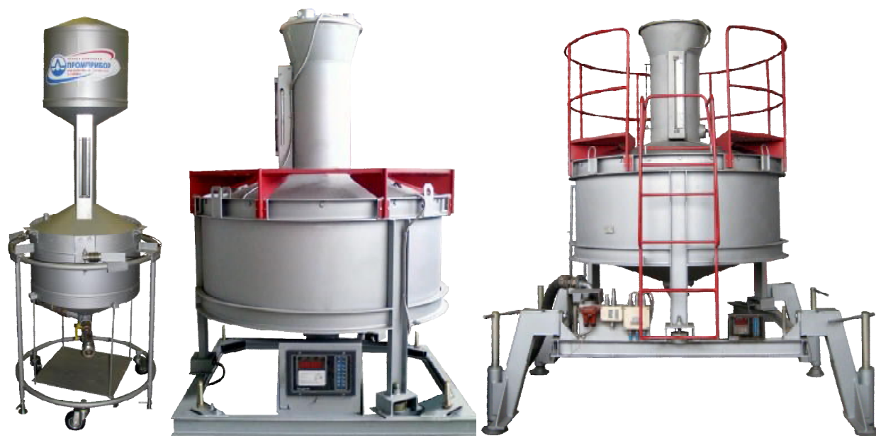
Рисунок 1 – Общий вид установок поверочных средств измерений объема и массы УПМ
