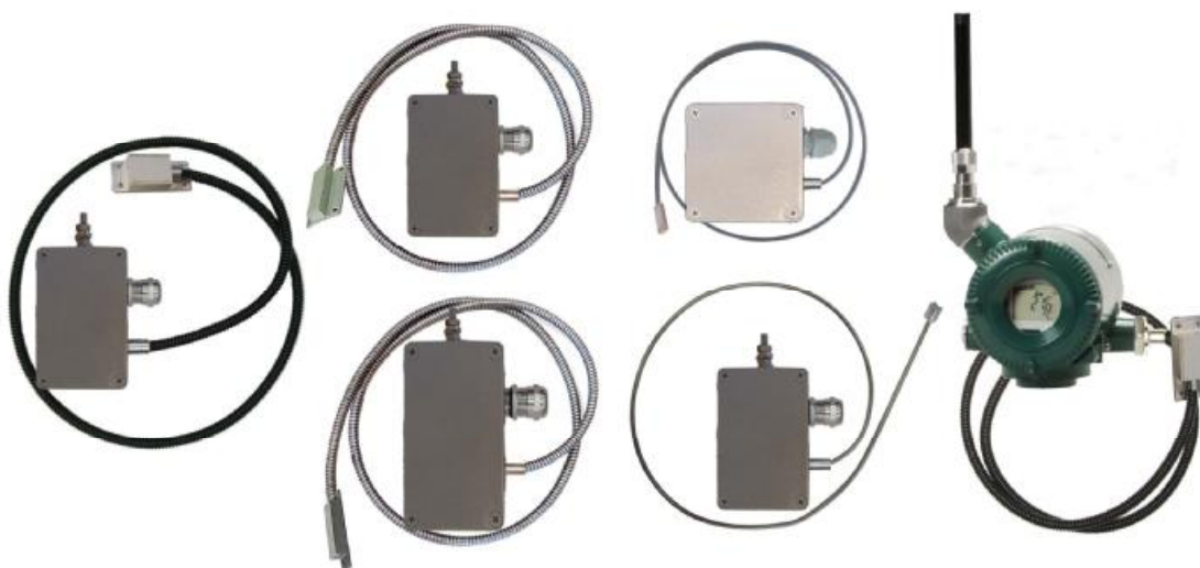
Рисунок 8 - Поверхностные общепромышленные ППТП/Оп и взрывозащищенные ППТП/Ехi с корпусами типов «К3М» - «К7»
