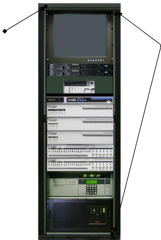
Рисунок 2 - Место нанесения знака утверждения типа и схема пломбировки
