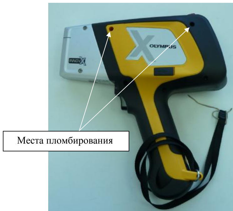
Рисунок 2 – Места пломбирования анализаторов рентгенофлуоресцентных Delta Element DE-2000, Delta Classic Plus (DCC-2000, DCC-2000-C, DCC-2000-CC), Delta Professional (DPO-2000, DPO-2000-C, DPO-2000-CC), Delta Premium (DP-2000, DP-2000-C, DP-2000-CC)
