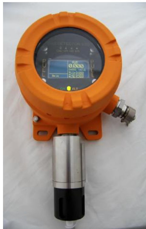
Рисунок 2 – Внешний вид газоанализатора ССС-903МЕ (HNO 3 ) (исполнение с УПЭС-903МЕ из алюминиевых сплавов)
