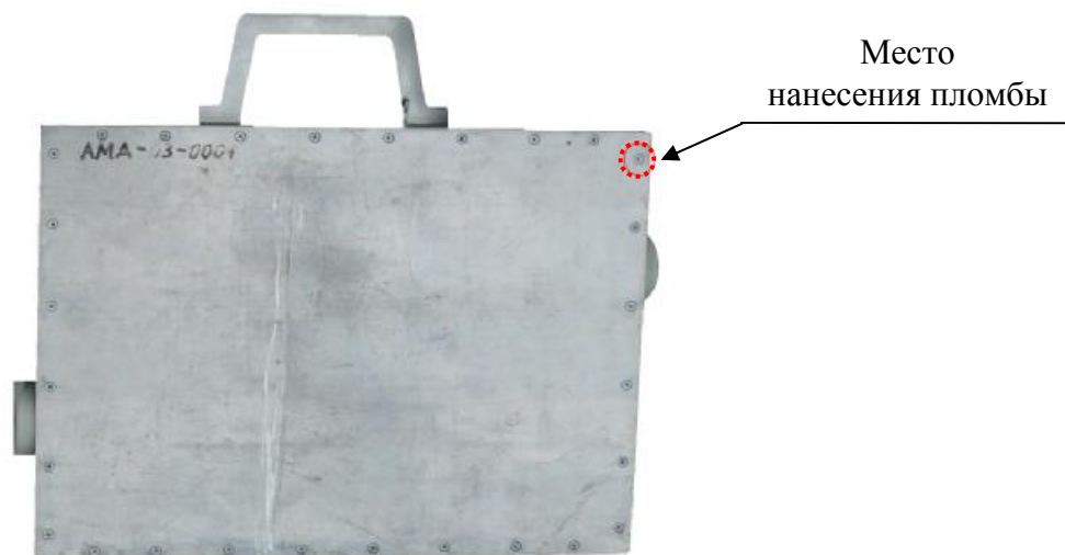
Рисунок 2 – Схема пломбировки блока регистрации и управления дефектоскопов
