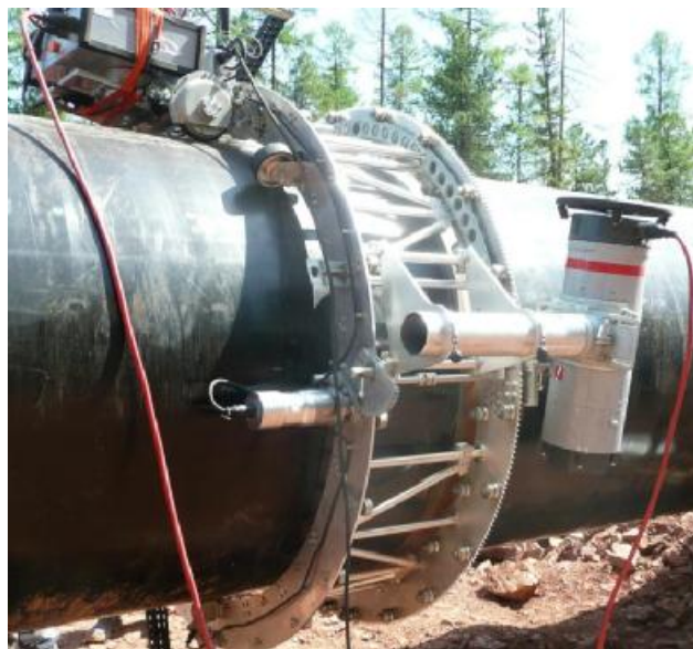
б) вид дефектоскопа со стороны рентгеновского аппарата
