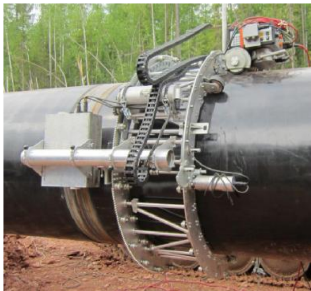
а) вид дефектоскопа со стороны блока регистрации и управления
