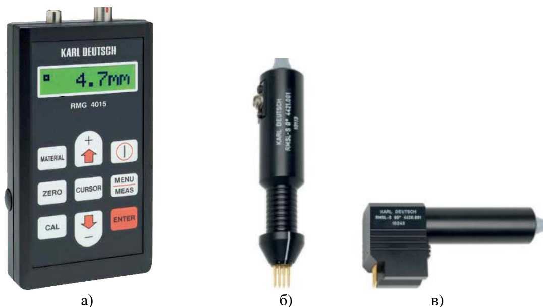
Рисунок 1 – Общий вид электронного блока и датчиков а) электронный блок; б) датчик RMSL-S 0°; в) датчик RMSL 90 °
