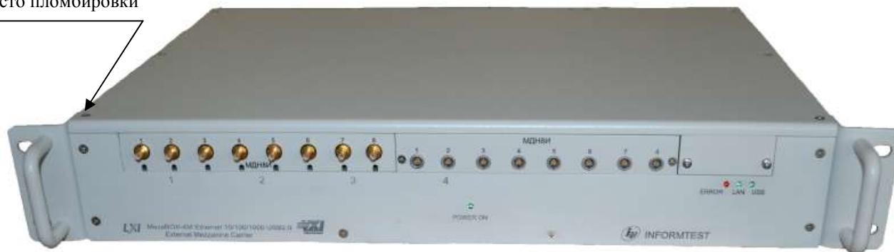
Рисунок 5 – Внешний вид устройства MezaBOX-4M LXI ФТКС.469133.013 с установленными измерителями МДН8И и МДН8И-01
