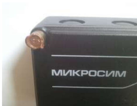
Рисунок 3 – Пломбировка преобразователя от несанкционированного доступа
