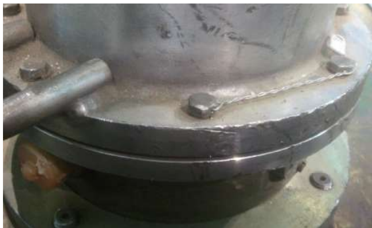
Рисунок 2 – Пломбировка датчика от несанкционированного доступа
