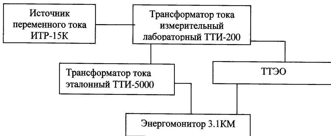
Рисунок 4. Схема для определения погрешности коэффициента преобразования силы переменного и постоянного тока
