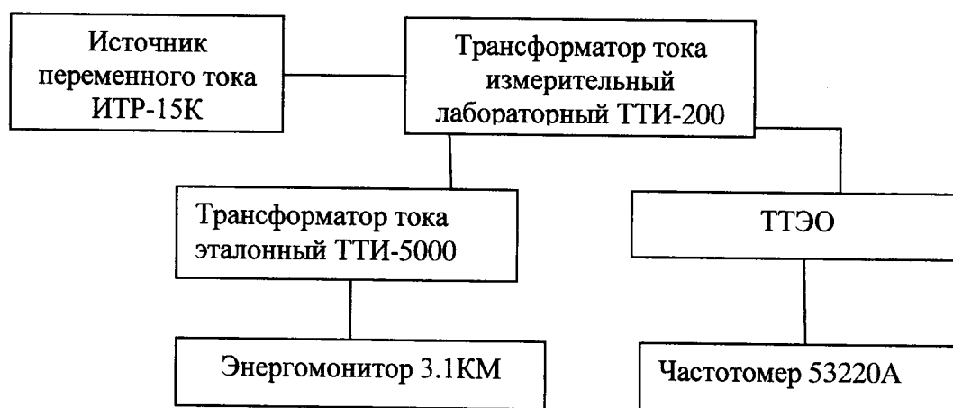
Рисунок 5. Схема для определения погрешности коэффициента преобразования силы переменного и постоянного тока
