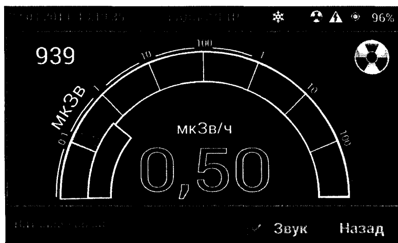
Рис. 60. Окно, отображающее скорость счета и индикацию мощности амбиентного эквивалента дозы для коллимированного пучка излучения ^{137}\text{Cs} .
