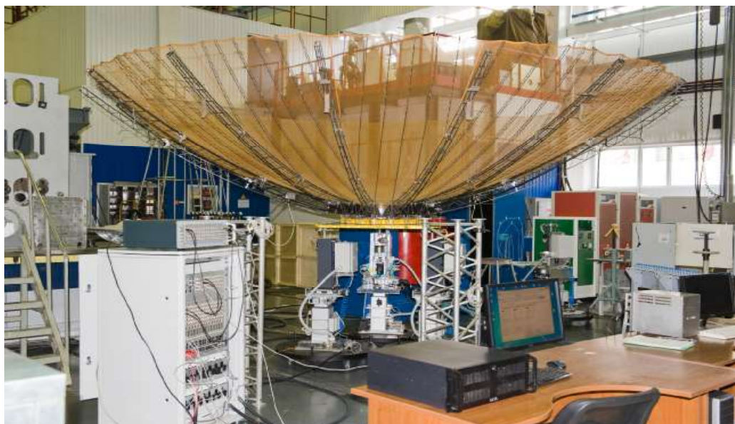
Рисунок 2 - Стенд №2 для контроля геометрических размеров, формы, деформаций крупногабаритных космических конструкций ракетно-космической техники с применением лазерных виброметров (общий вид)
