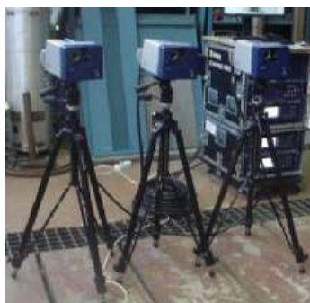
Рисунок 4 - Трехмерный лазерный сканирующий виброметр PSV-400-3D в рабочем положении
