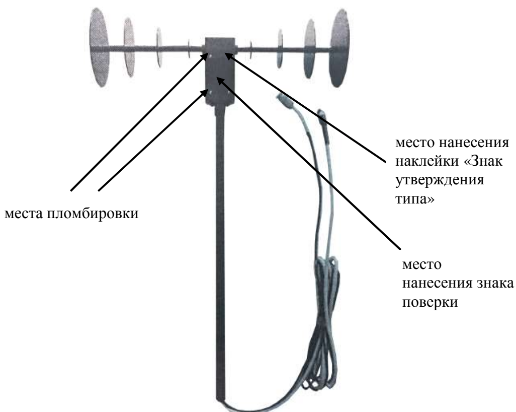
Рисунок 1 - Фото общего вида антенны дипольные активные П6-51М/1
