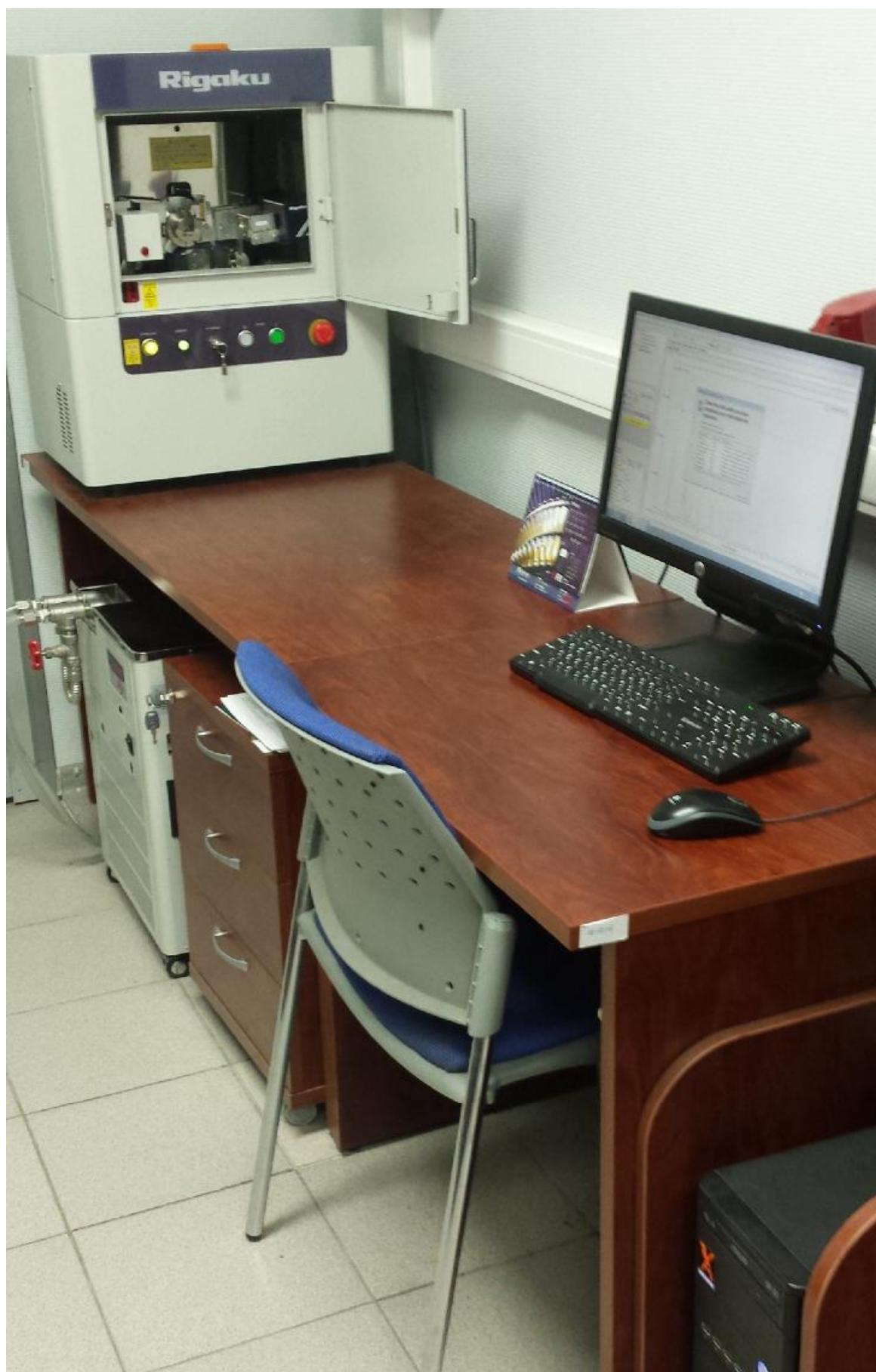
Рисунок 1. Внешний вид дифрактометра Знак поверки наносится на заднюю стенку установки рядом с наклейкой знака утверждения типа, см. рисунок 2.
