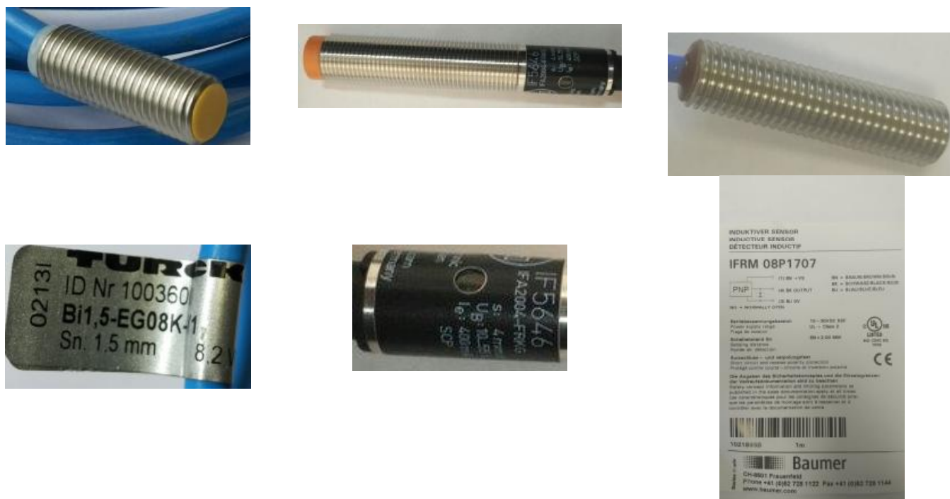
Рисунок 9 - Внешний вид вихретоковых преобразователей IF5646, IFRM 08P1707 и Bi1,5-EG08K-Y1
