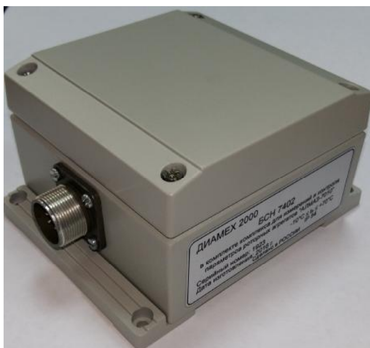
Рисунок 4 - Внешний вид блока согласования-нормализации БСН7402
