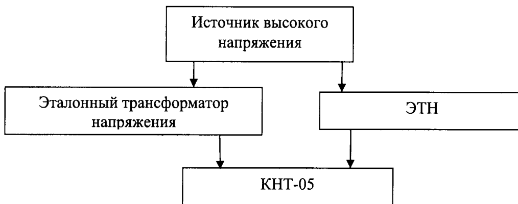
Рисунок 1 - Схема для проверки допускаемой относительной погрешности измерения напряжения переменного тока
