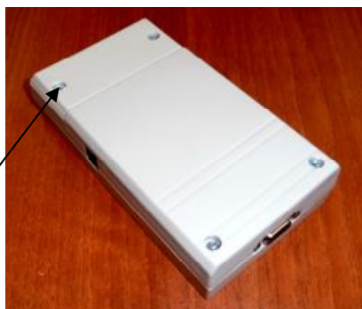
Рисунок 2 - Место пломбировки от несанкционированного доступа.
