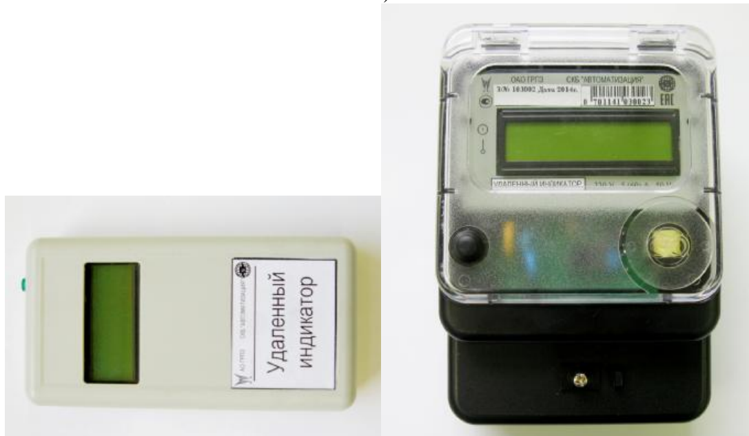
Рисунок 2 - Внешний вид счётчиков с указанием мест пломбировки и нанесения знаков поверки: а) счётчик для внутренней установки; б) счётчик с разделенной архитектурой; в) удаленный индикатор для счётчика с разделенной архитектурой
