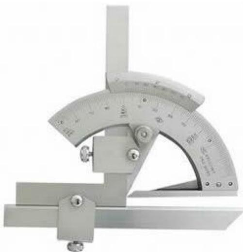
Рисунок 1 – Общий вид угломеров
