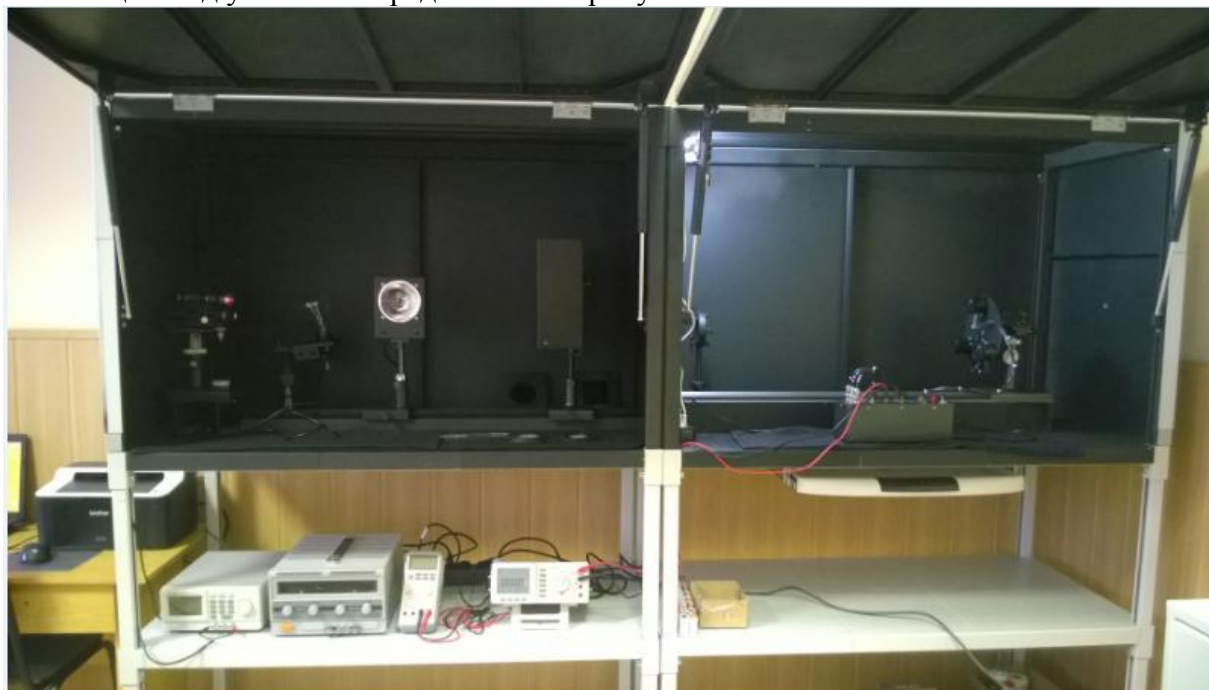
Рисунок 1 – Общий вид установки для поверки и калибровки люксметров и яркомеров «СТИЛЬБ-7»
