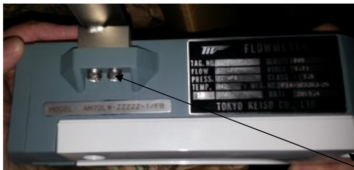
Рисунок 2 - Обозначение места пломбировки ротаметра М-901
