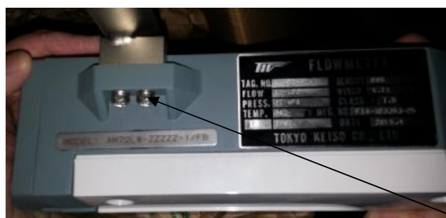
Рисунок 2 - Обозначение места пломбировки ротаметров М-901
