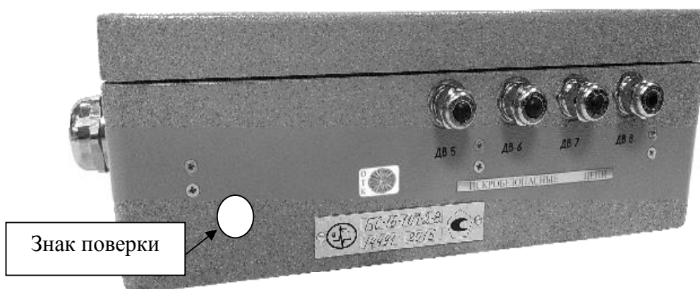
Рисунок 1 - Внешний вид блока согласующего БС-16-11М, обозначение места для нанесения знака поверки
