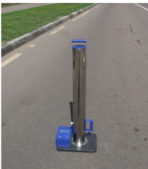
Рисунок 13 - Измеритель упругого прогиба дорожного покрытия Микродин-3
