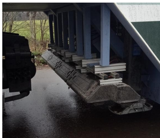
Рисунок 10 - Измеритель толщины дорожного покрытия ТЕРРА-ЗОНД
