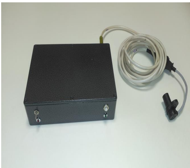
Рисунок 3 - Измеритель длины (протяженности) участков дорог ИП-10
