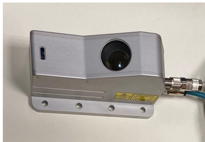
Рисунок 16 - Измеритель коэффициента сцепления дорожного покрытия ПКСН-3
