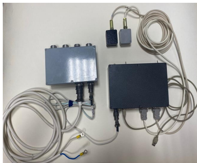
Рисунок 8 - Измеритель ровности и ординат микропрофиля дорожного покрытия РИКАД-3
