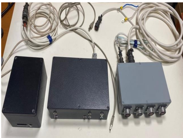
Рисунок 9 - Измеритель ровности и ординат микропрофиля дорожного покрытия РИКАД-4
