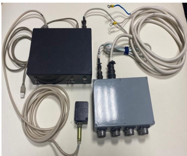
Рисунок 7 - Измеритель ровности и ординат микропрофиля дорожного покрытия РИКАД-2
