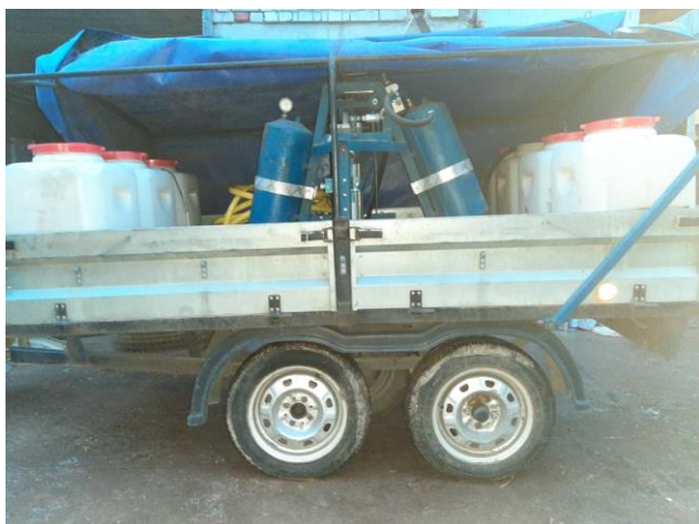
Рисунок 15 - Измеритель коэффициента сцепления дорожного покрытия ПКСН-2
