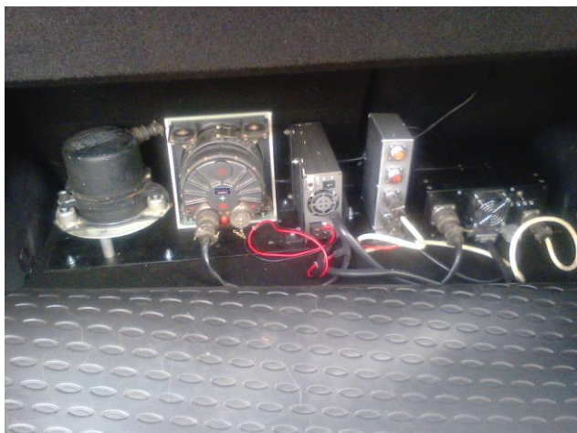
Рисунок 5 - Измеритель продольных и поперечных уклонов, углов поворота и радиусов кривых в плане ГИРОСКОП
