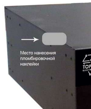
Рисунок 16 - Пломбировка устройства крейтового исполнения с процессором 820
