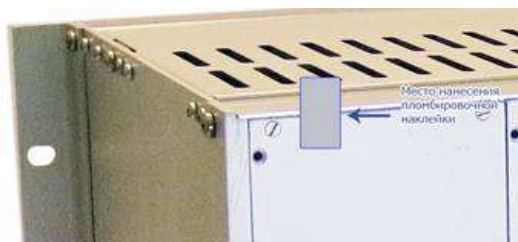
Рисунок 15 - Пломбировка устройства крейтового исполнения
