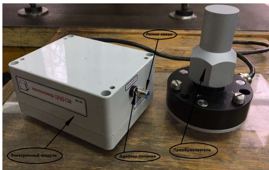
Рисунок 1 - Внешний вид наклономеров двухкоординатных цифровых ЦНД-СМ
