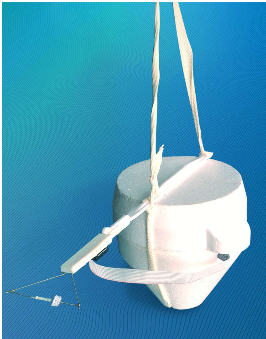
Рисунок 1 - Внешний вид радиозонда
