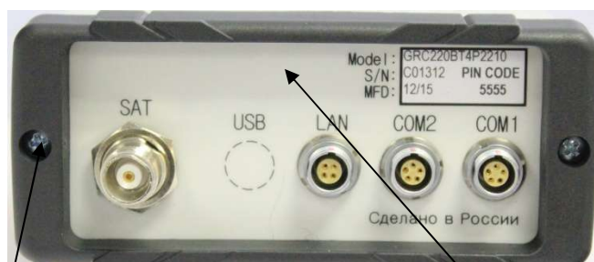
а - место пломбировки б - место нанесения наклейки со знаком утверждения типа (нижняя панель)
