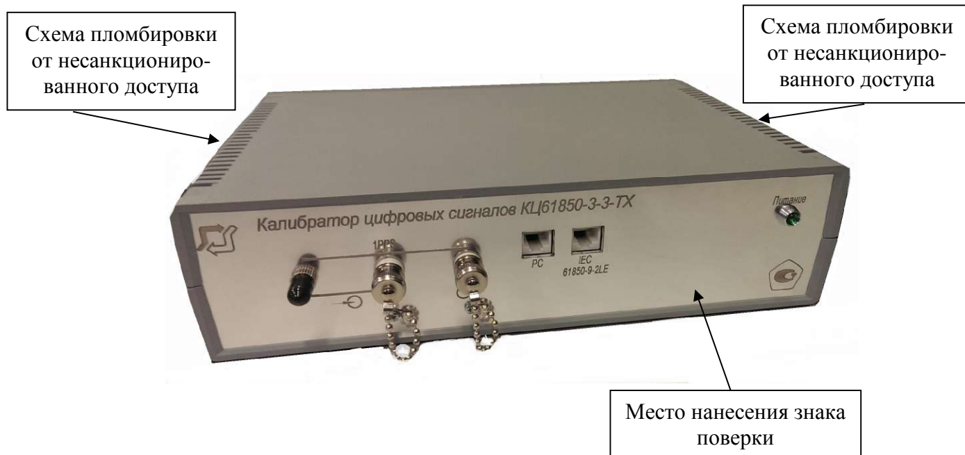
Рисунок 1- Общий вид аппаратной части калибраторов, схема пломбировки от несанкционированного доступа, обозначение места нанесения знака поверки
