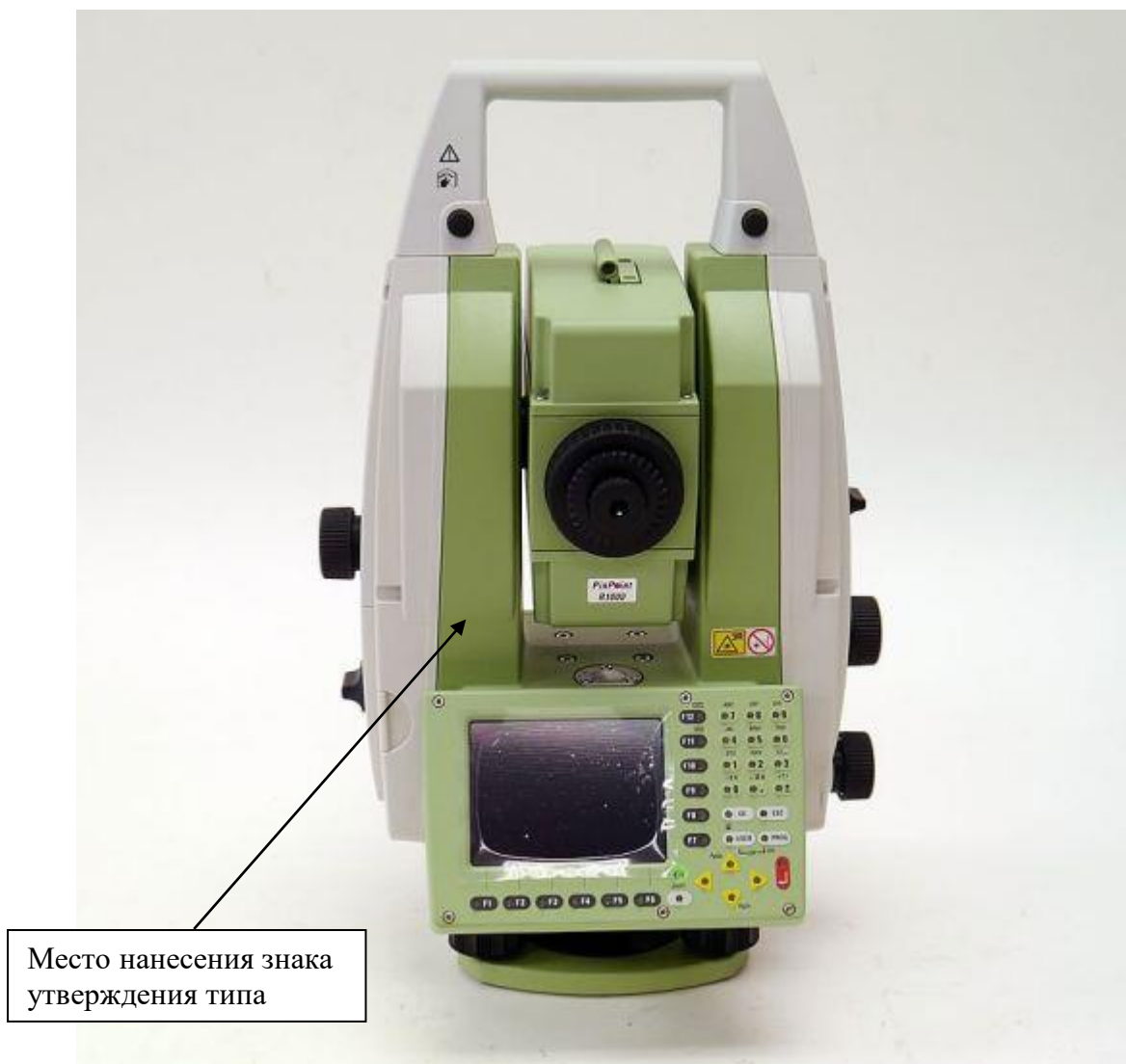
Рисунок 1 - Общий вид тахеометра с указанием места нанесения знака утверждения типа
