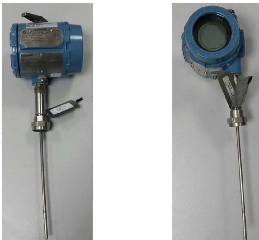
Рисунок 1 - Общий вид датчиков температуры 3144Р
