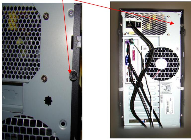
Рисунок 2 - Схема пломбировки ПЭВМ от несанкционированного доступа
