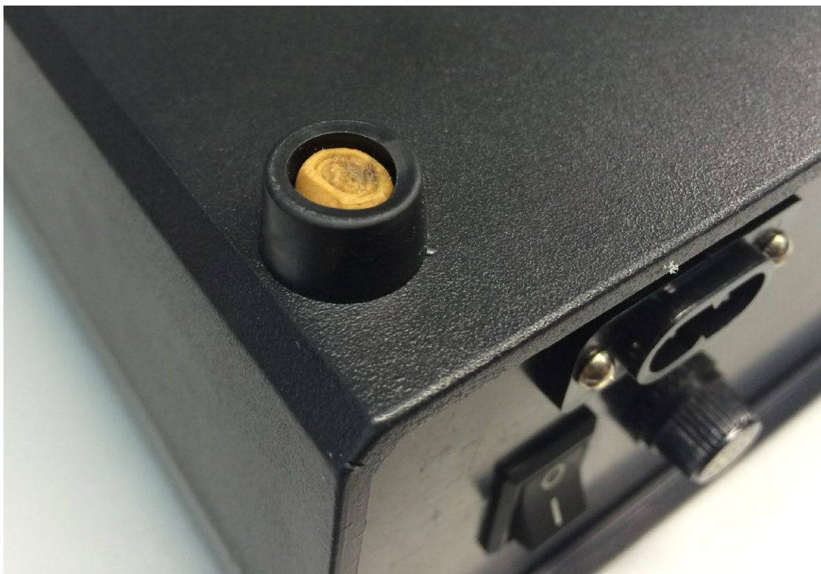
Рисунок 2 - Схема пломбировки от несанкционированного доступа
