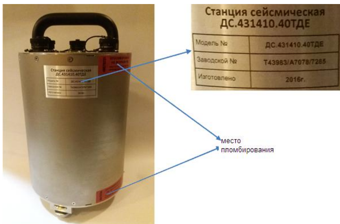
Рисунок 2 - Схема пломбировки от несанкционированного доступа
