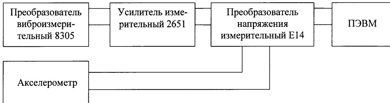
Рисунок 1. Схема подключения эталонного акселерометра.
