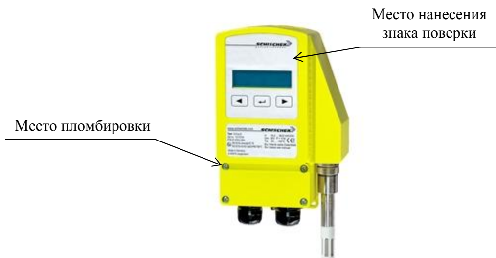
Рисунок 1 - Датчик относительной влажности модификации ExPro-CF-50 с преобразователем измерительным модификации ExCos-D
