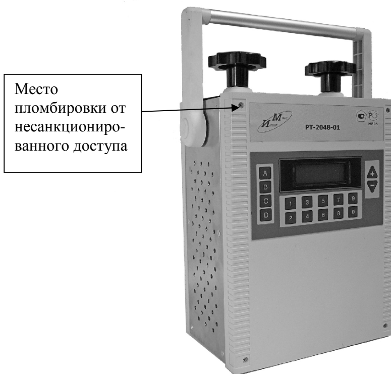
Рисунок 1 - Общий вид комплекта РТ-2048-01 и место пломбировки от несанкционированного доступа
