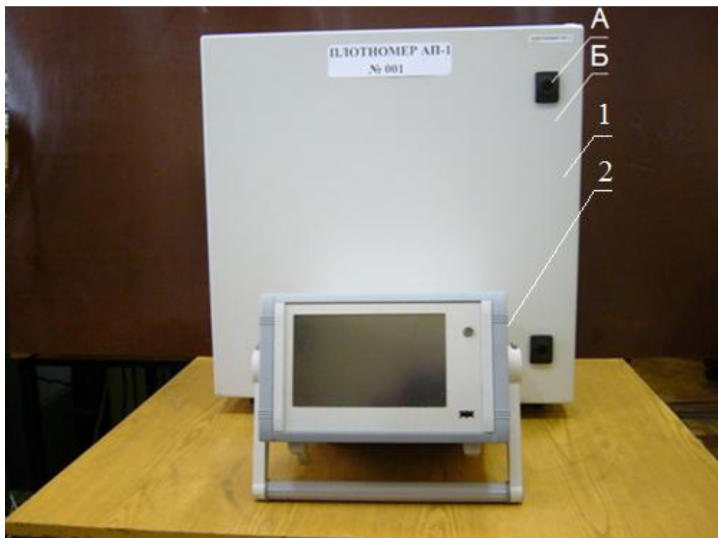
Рисунок 1 - Общий вид плотномеров природного газа автоматических АП-1: 1 - блок измерения плотности газов, 2 - система ССОО; (позиция «А» обозначает место пломбирования, позиция «Б» обозначает место нанесения знака поверки)
