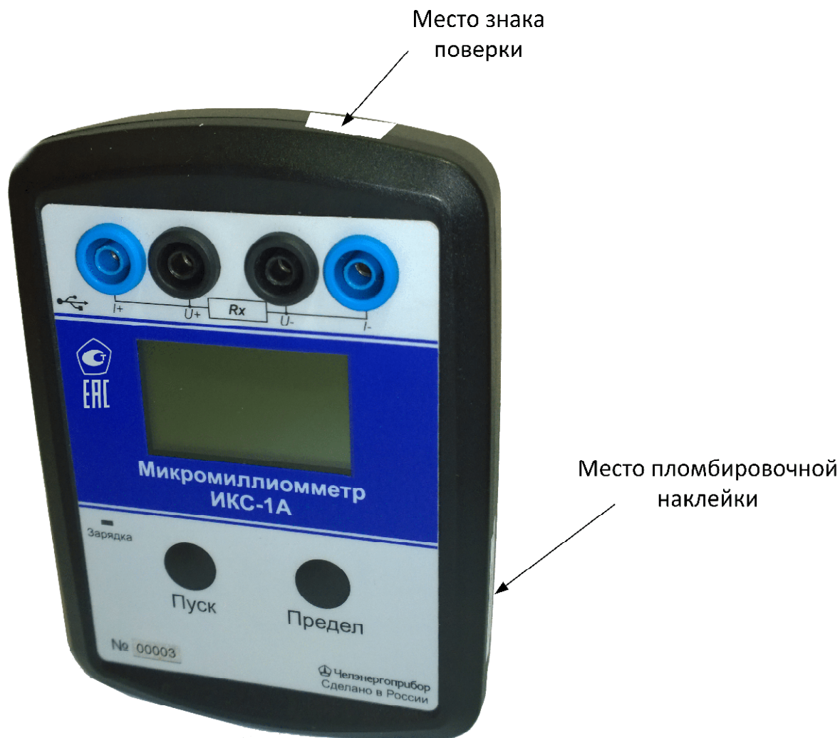
Рисунок 1 - Внешний вид измерителя с местами пломбирования и местом нанесения знака поверки
