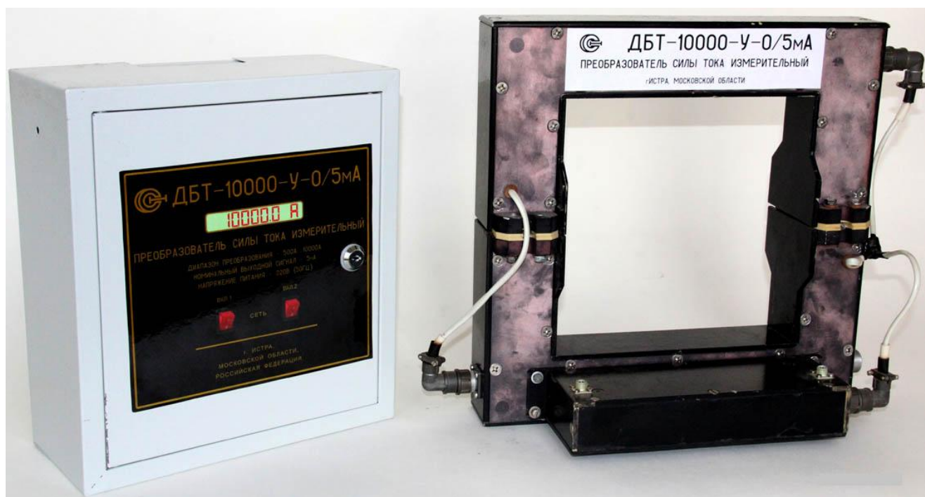
Рисунок 2 – Общий вид преобразователя ДБТ-10000-У-0/5
