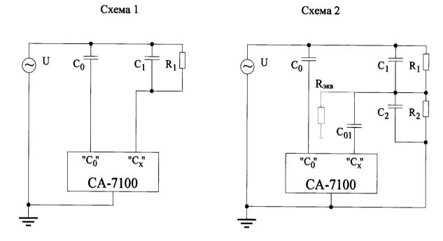
$C_1$  и  $C_2$  – емкости высоковольтного и низковольтного плеч делителя напряжения;
