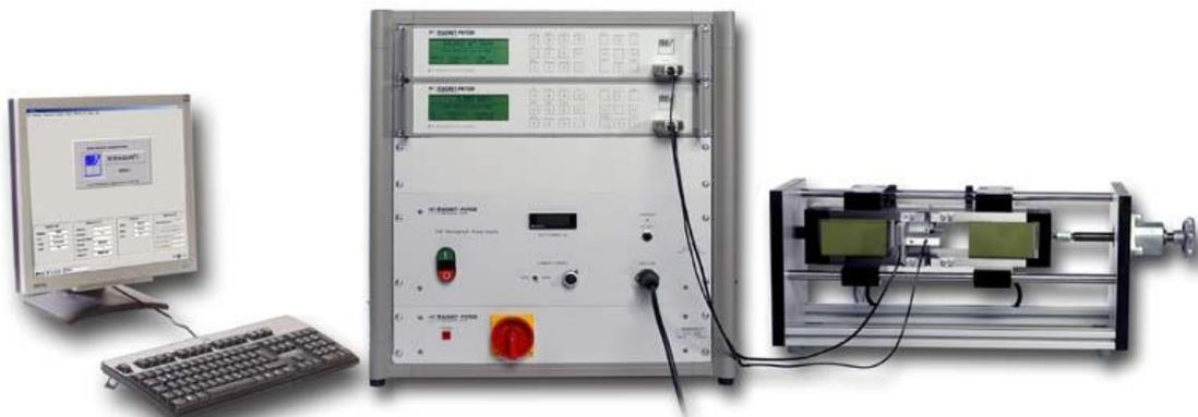
Рисунок 1 – Общий вид установки автоматической компьютеризированной REMAGRAPH C-500
