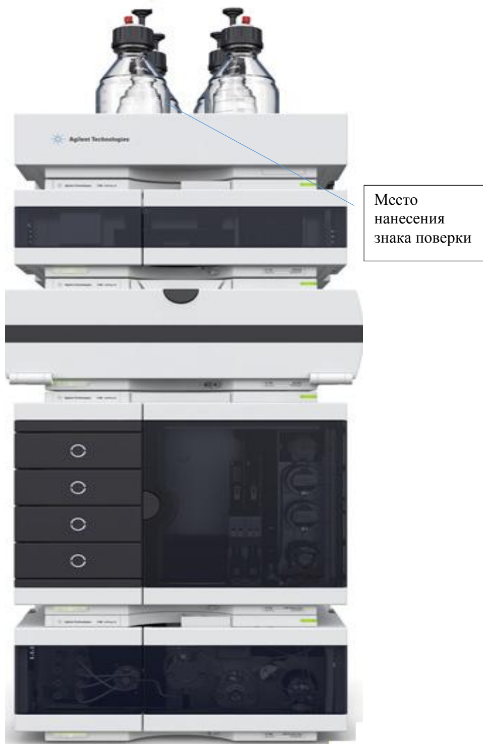
Рисунок 2 - Внешний вид хроматографа жидкостного 1260 Infinity II LC (внешний вид зависит от включенных в систему модулей)
