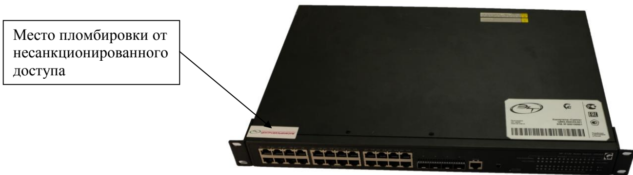
Рисунок 5 - Место пломбировки от несанкционированного доступа коммутатора ЦВКЕ.468349.001
