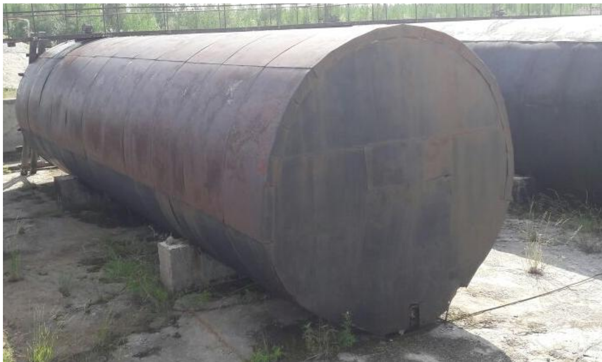
Рисунок 1 - Общий вид резервуара РГС-60
